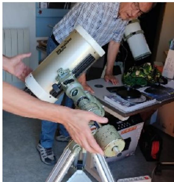
7. **Régler le chercheur** : important ! **il faut d'abord « recaler son socle à sa place »** (voir marque sur le tube): puis on vise un point éloigné « au fusil », que l'on centre dans l'oculaire à l'aide des manettes (et bien entendu, **moteur débrayé**). Puis on vérifie que cet objet est bien dans le chercheur, sinon régler avec les vis.
