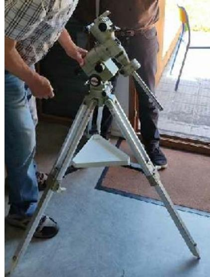
2. L’orienter vers la Polaire à la boussole / vérifier que la vis moteur R.A. est débrayée
